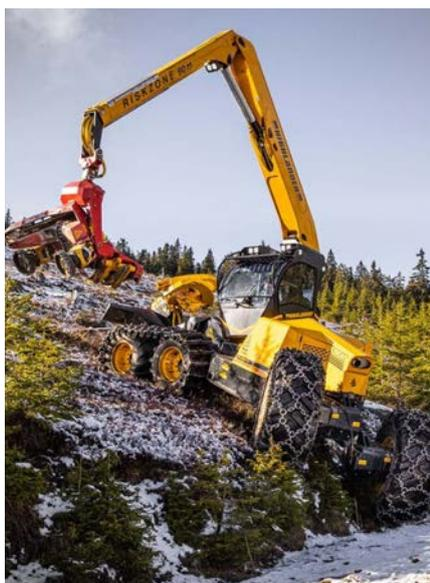
**Der Radharvester HIGHLANDER arbeitet selbst dort effizient, wo andere aufgrund der Steilheit bereits mit Seilkrananlagen arbeiten müssen. Zentrales Element ist das Harvester-Aggregat WOODY, der Bäume in einem Arbeitsgang fällt und in transportgerechte Stücke schneidet.**
