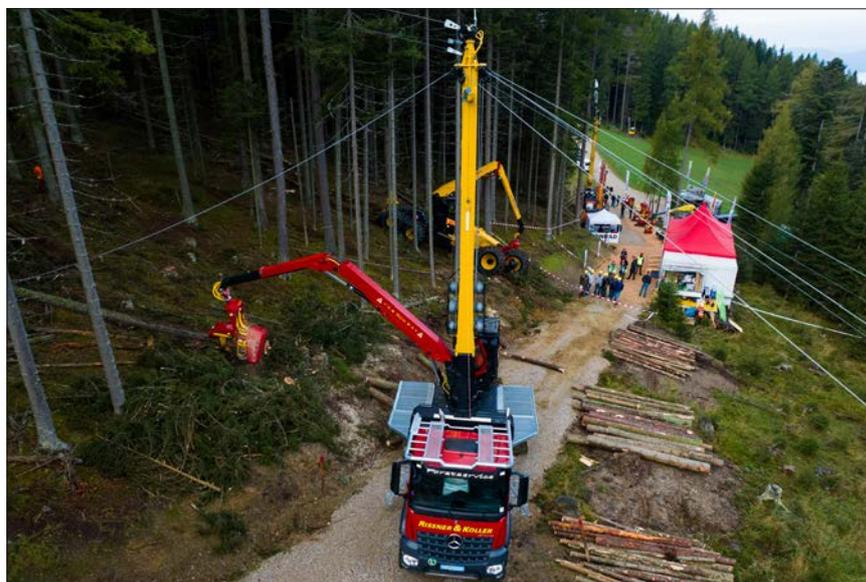
KONRAD Forsttechnik entwickelt und produziert Holzerntemaschinen für steiles Gelände. Im Bild die Seilkran-Kombinationsmaschine Mounty mit Harvesteraggregat Woddy für die Holzernte und die Seilkrananlage für die Holzbringung.
