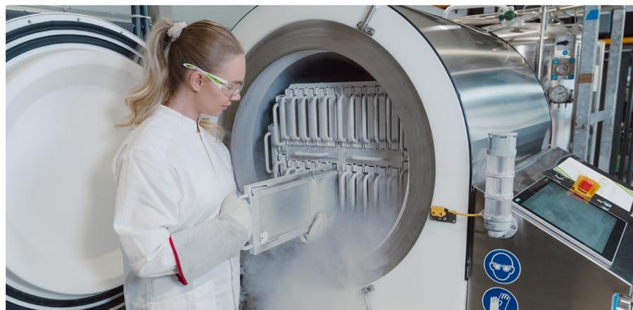
Die Einfrier- und Auftauanlagen der Serie RoSS.LN2F von Single Use Support ermöglichen das Einfrieren von Kulturen für die Zell- und Gentherapie bis zu -170 °C.
