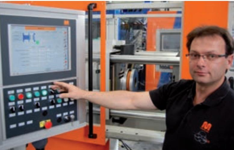
Die Visualisierung läuft auf einem ergonomisch schwenkbaren kundenspezifisch gestalteten B&R Automation Panel AP900 mit 15-Zoll Touchscreen.
