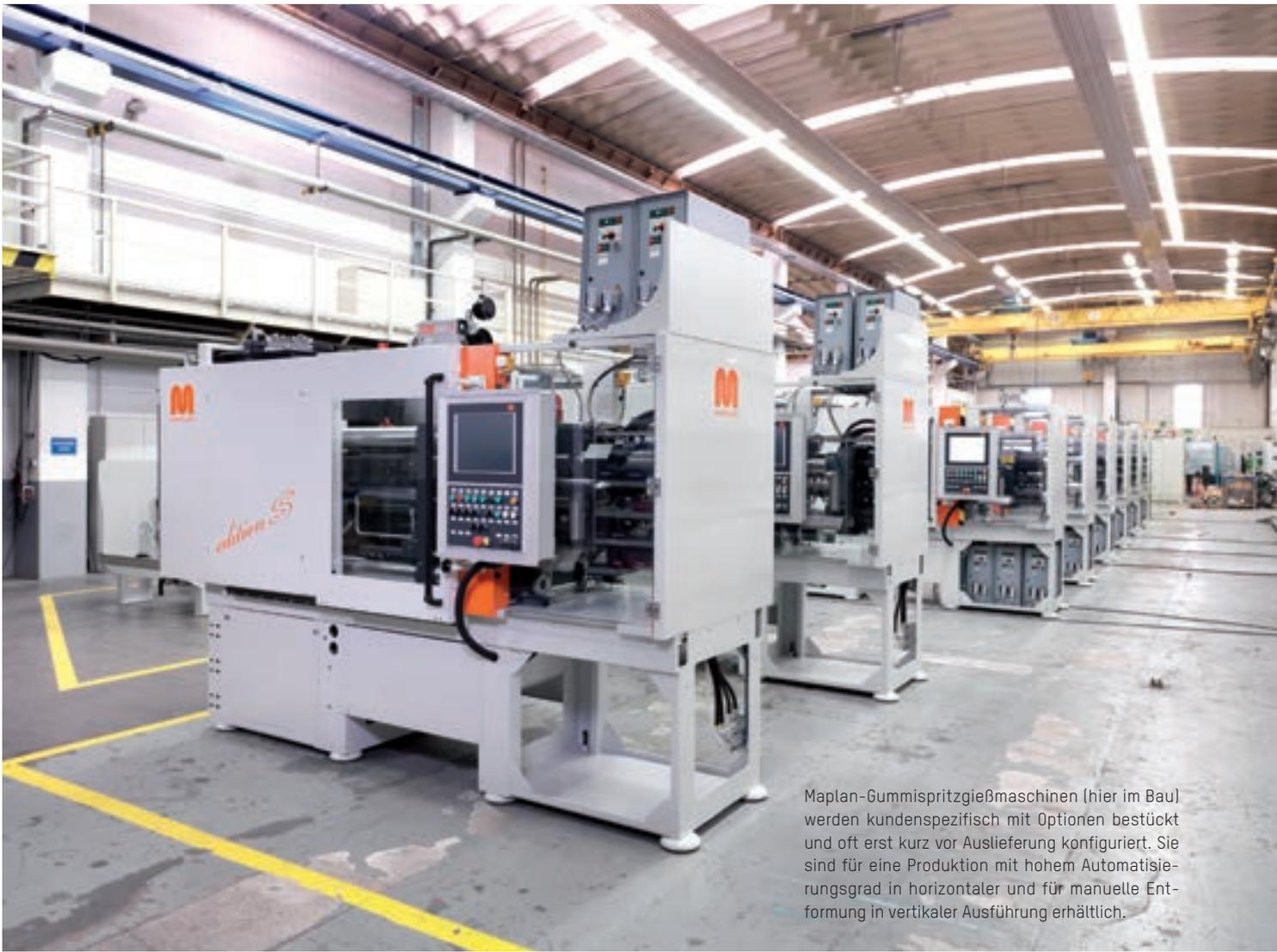
Maplan-Gummispritzgießmaschinen (hier im Bau) werden kundenspezifisch mit Optionen bestückt und oft erst kurz vor Auslieferung konfiguriert. Sie sind für eine Produktion mit hohem Automatisierungsgrad in horizontaler und für manuelle Entformung in vertikaler Ausführung erhältlich.
