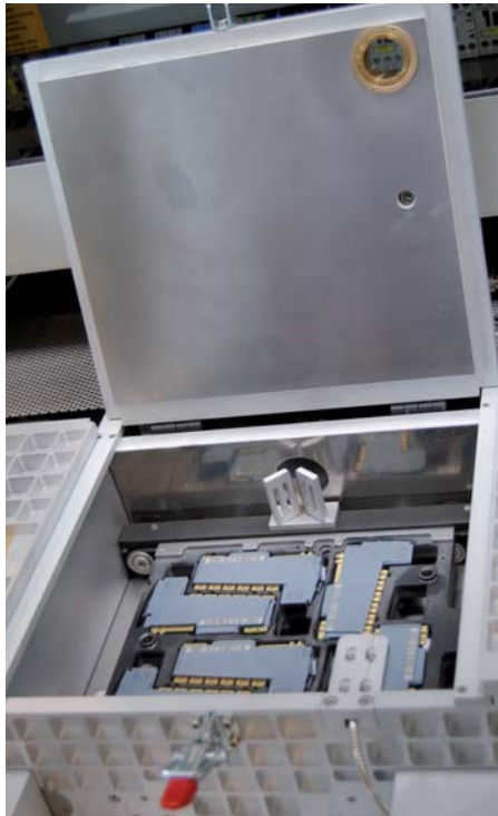
Drei Kammern: In diesen werden die X20-Analogmodule bei 60 °C zu 100% getestet.
