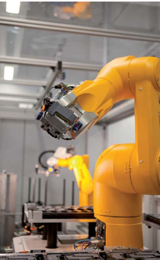
Umladen in spezielle Teileträger für die Prüfung: Ein B&R-gesteuerter Knickarmroboter erledigt diese Aufgabe.
