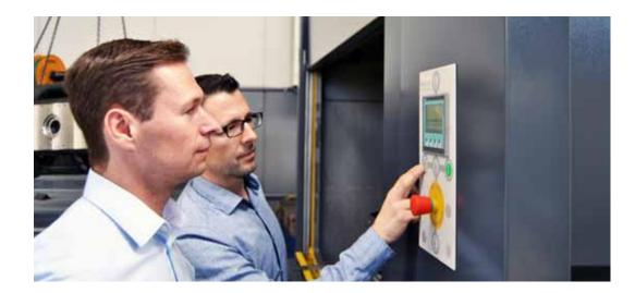
Steuerung und Visualisierung der Entfettungsanlage erfolgen ergonomisch über ein Siemens-Panel mit Farb-Touchscreen. Im Bild Günter Redhammer (hinten) mit Gerald Leeb.
