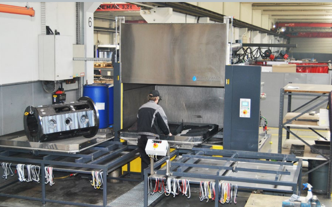
Die Reinigung von Teilen zur Lackiervorbereitung erfolgt in einer Zweibad-Reinigungsanlage BUPI CLEANER® POWERTEC PRO.
