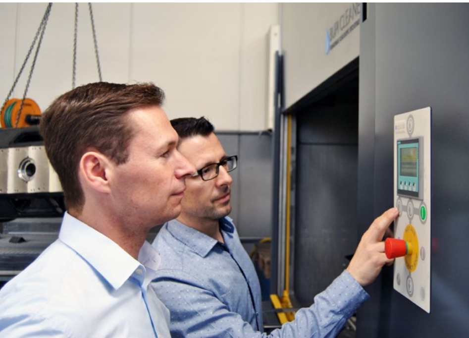
Steuerung und Visualisierung der BUPI CLEANER® POWERTEC PRO Entfettungsanlage erfolgen ergonomisch über ein SIEMENS-Panel mit Farb-Touchscreen. Im Bild Günter Redhammer (hinten) mit MAP PAMMINGER Kundenberater Gerald Leeb.
