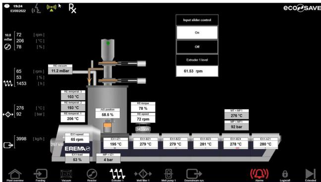
EREMA nutzt für die Erstellung der Visualisierung Smart Objects. Damit schaffen sie durch reines Konfigurieren einfach zu interpretierende und zu bedienende Benutzeroberflächen.
