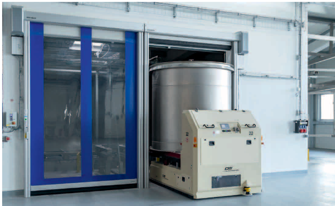
Nach dem Mischen bringt das Regalbediengerät des Hochregallagers die Chargenbehälter zur Ebene 2. Dort unterfahren ebenfalls kundenspezifische mobile Roboter die Container und bringen sie zu den vier Entleerungsplätzen.
