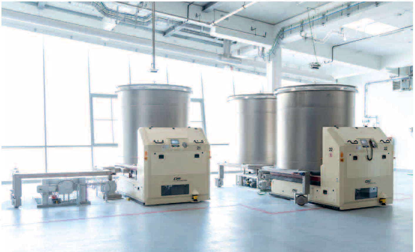
Nach der Entleerung der Restmengen erfolgt der Transport durch dieselben mobilen Roboter zur Trockenreinigung und zurück zum Hochregallager. Die Inhalte der direkt am Fahrzeug angebrachten Visualisierung lassen sich auch auf das Terminal oder ein Smartphone übertragen.
