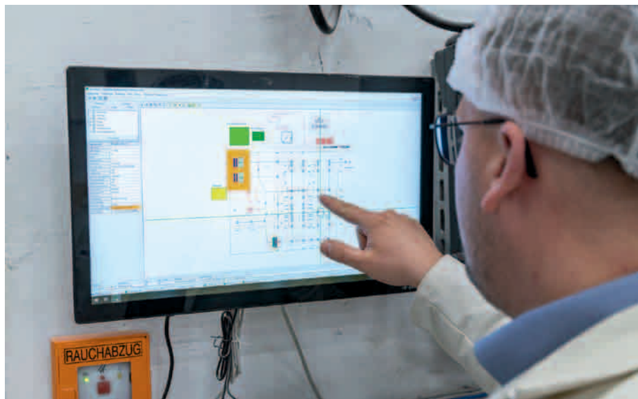
Der Flottenmanager berechnet mittels prädiktiver Modelle die optimierten Routen entlang der Linien eines engmaschigen Schachbrettmusters und zeigt die tatsächlichen Fahrzeugpositionen und -zustände in Echtzeit in einem grafischen Systemlayout an. Die Visualisierung ist web-basiert aufgebaut und kann daher nicht nur am Leitstand, sondern auch auf anderen Rechnern oder Handgeräten angezeigt werden.
