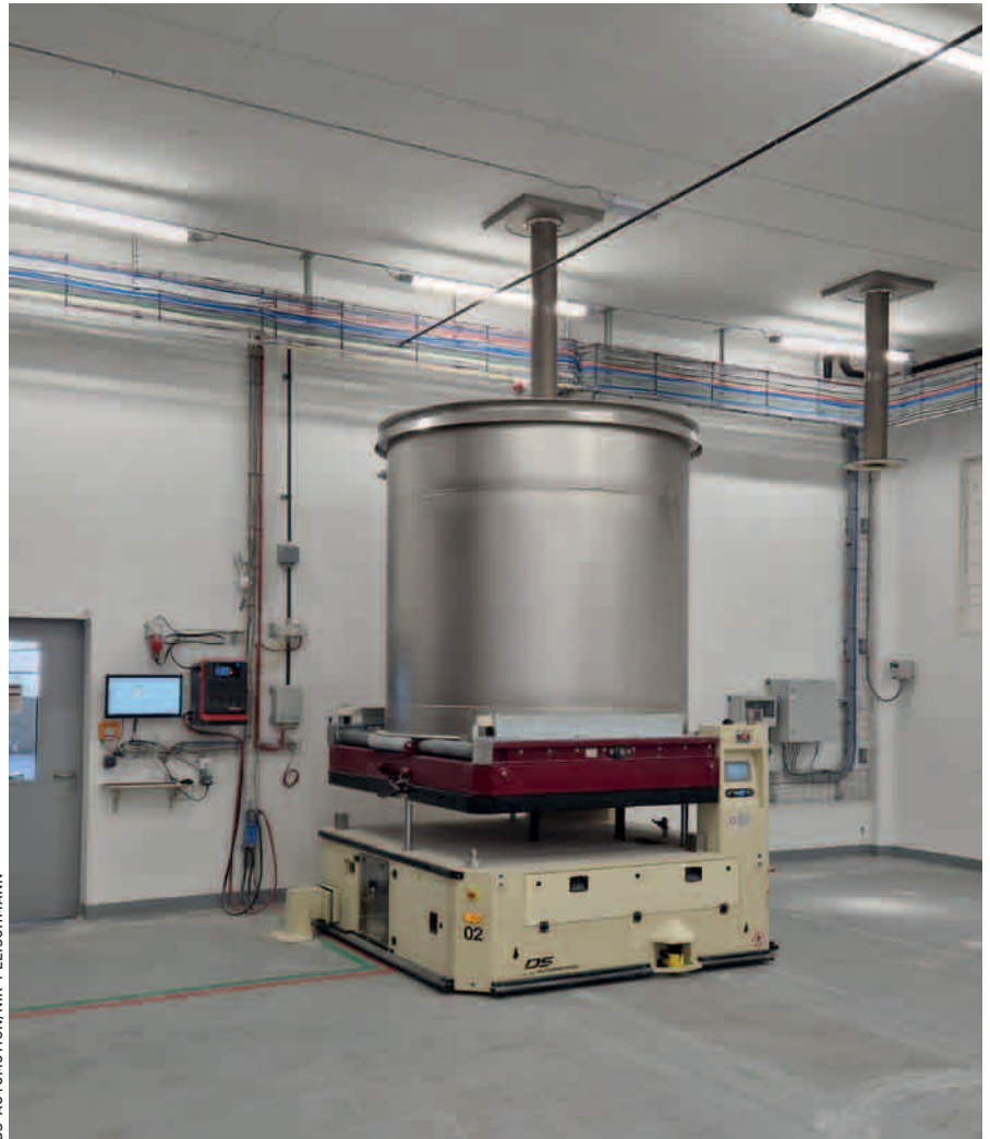
Die mobilen Roboter fahren frei navigierend mittels Koppelnavigation mit Magneten die Entnahmestellen an der Decke an, öffnen den Deckel des Behälters und heben diesen an, sodass er am Entnahmepunkt staubdicht andockt.
