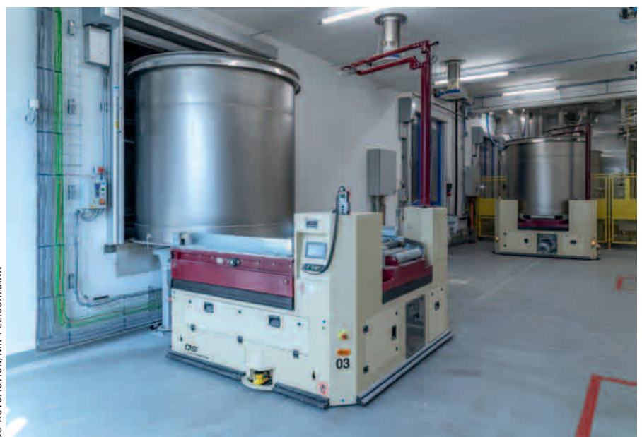
Das Fahrerlose Transportsystem bedient zahlreiche Schnittstellen zu anderen Systemen wie dem MES-System, Kettenförderern, Schiebe- und Rolltoren und verschiedenen SPS-Steuerungen.
