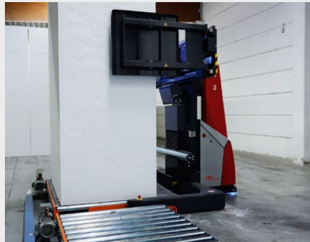
Die freie Navigation mit punktueller Referenzierung ermöglicht eine genaue Positionierung für die Lastübernahme und -übergabe.
