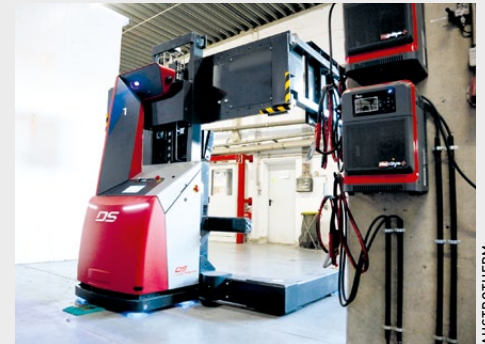
Die Ladekontakte, an denen die FTS ihre Blei-Gel-Akkus aufladen, sind im Gelände verteilt. So werden lange unproduktive Wege vermieden.
