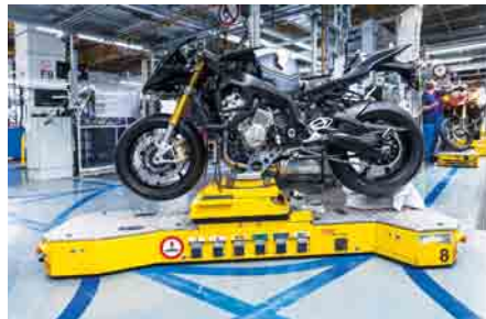
Bis zu 800 Motorräder pro Tag produziert das BMW-Werk Berlin. Die Montage der Zwei- und Vierzylindermodelle erfolgt auf einem Fahrerlosen Transportsystem.
