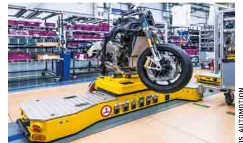
Das kundenspezifische Transportfahrzeug ist bei einer Tragfähigkeit von 400 Kilogramm kaum größer als der „Fußabdruck“ des Motorrades. Der Akku wird permanent aus der Spurführungs-Schleife nachgeladen, was die Verfügbarkeit maximiert.
