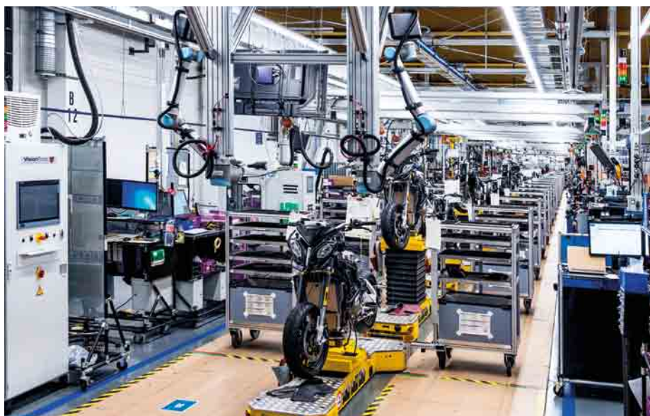
Die Produktionstechniker im Werk statteten das FTS mit Beiwagen für den Werkzeug- und Teiletransport aus. Diese werden am Beginn und Ende jeder Station per Magnet an- und abgekoppelt.
