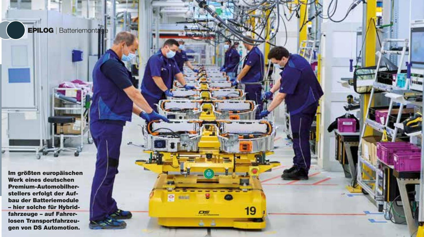
Im größten europäischen Werk eines deutschen Premium-Automobilherstellers erfolgt der Aufbau der Batteriemodule – hier solche für Hybridfahrzeuge – auf Fahrerlosen Transportfahrzeugen von DS Automotion.
