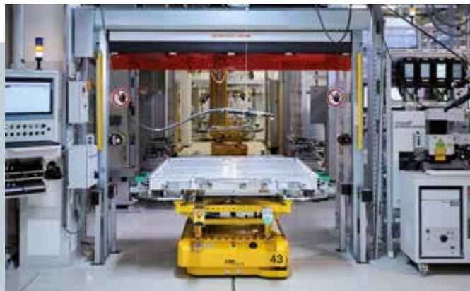
**Auf 50 Fahrerlosen Transportfahrzeugen desselben Typs durchlaufen Hochvoltspeicher für vollelektrische Autos die automatisierten Montageschritte.**
