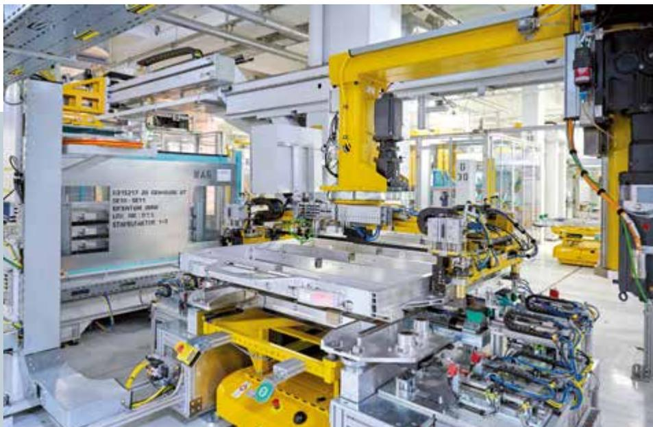
**Die durch Differenzialantrieb äußerst wendigen, anwendungsoptimierten Fahrerlosen Transportfahrzeugen können auch im Rückwärtsgang in die Montagezellen einfahren und sind in allen Batteriemontagelinien dieses Herstellers weltweit im Einsatz.**
