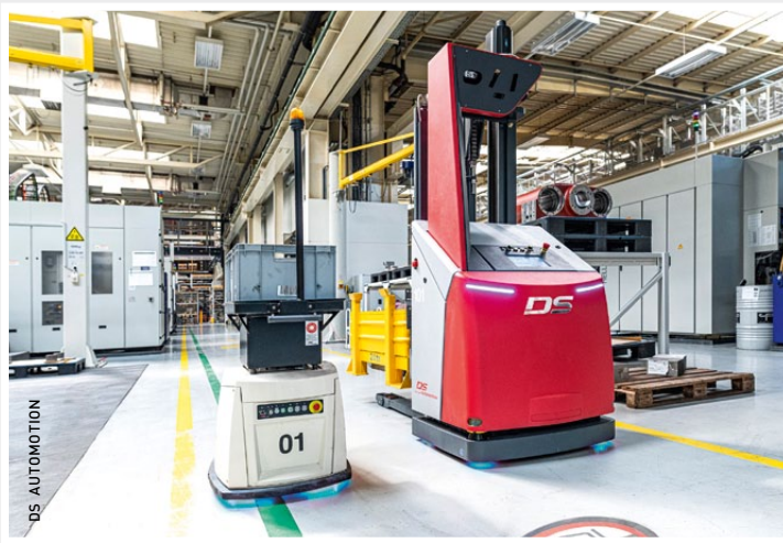
„Amadeus“ begegnet dem Kleinlasten-FTF „Sally“ von DS Automotion, das per Konturnavigation hauptsächlich Werkzeuge und Messmittel zu den Bearbeitungszentren bringt.
