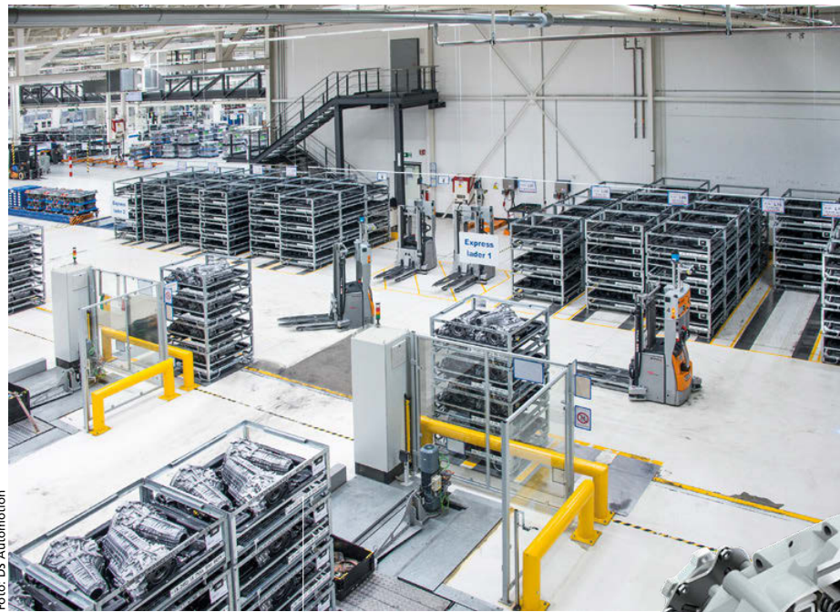
Vier automatisierte Hochhubwagen transportieren Getriebe zur Lkw-Ladestation.
