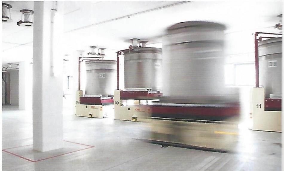
Die Backzutaten-Fertigmischungen werden bei Ireks in Chargenbehältern mittels fahrerlosem Transportsystem befördert
