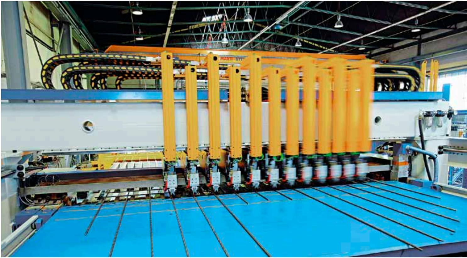
Die Schlatter-Maschine M630 Tailor ermöglicht eine äußerst flexible Produktion, sie fertigt komplexe Bewehrungsgitter in nahezu jeder beliebigen Geometrie.
