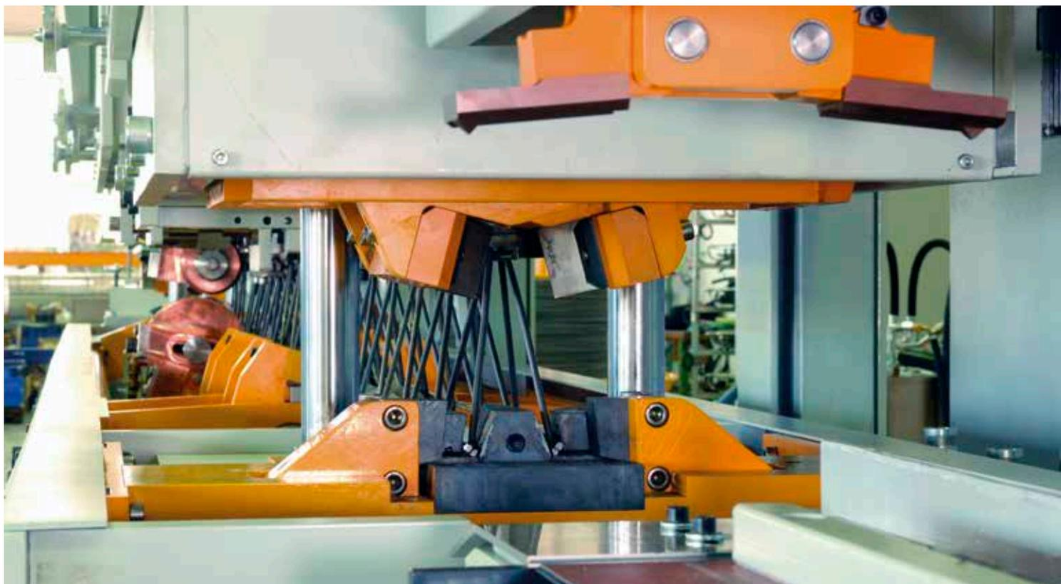
Auf der Gitterträgeranlage CTM310 lassen sich Träger mit einer Geschwindigkeit von bis zu 18 m/min auch bei sehr kleinen Losgrößen effizient und wirtschaftlich produzieren.
