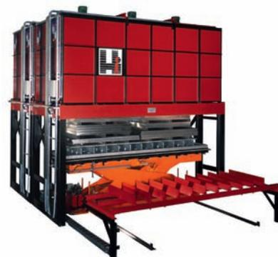
Die 1947 gegründete HOFMANN Wärmetechnik ist auf Öfen für die Wärmebehandlung von Aluminiumteilen spezialisiert, wie diesen Überkopf-Altenerungsöfen für Aluminiumplatten zur Weiterverarbeitung in Flugzeugbauelemente mit 30 Tonnen Fassungsvermögen.
