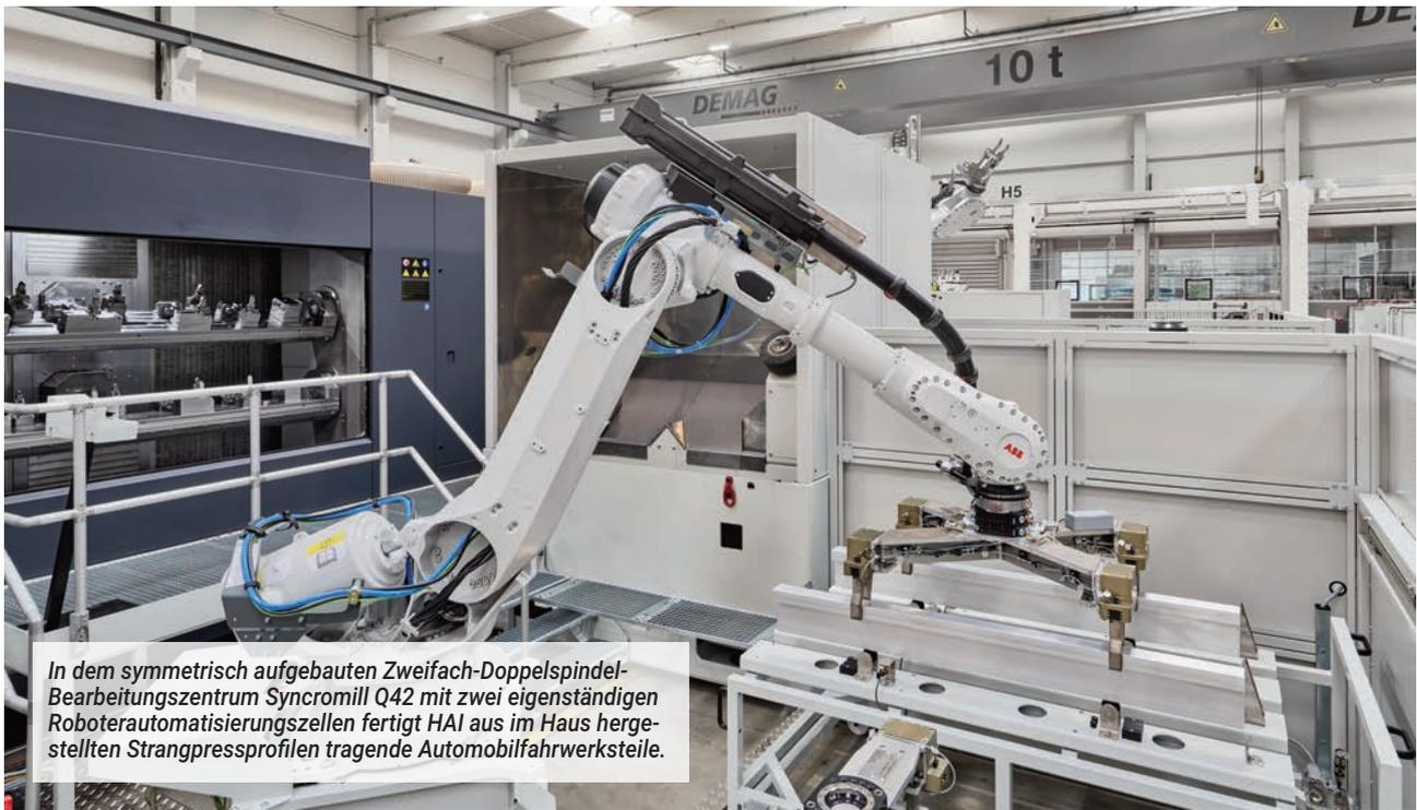
In dem symmetrisch aufgebauten Zweifach-Doppelspindel-Bearbeitungszentrum Syncromill Q42 mit zwei eigenständigen Roboterautomatisierungszellen fertigt HAI aus im Haus hergestellten Strangpressprofilen tragende Automobilfahrwerksteile.
