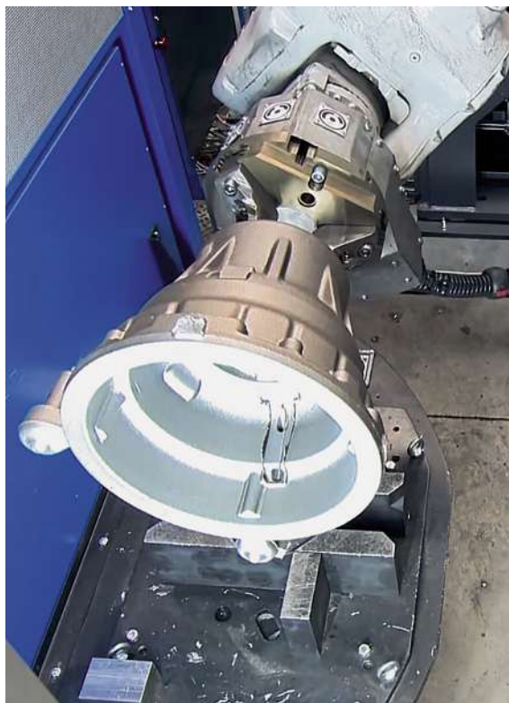
Die Lagebestimmung per Kamera erspart Zeit und Spannmittel für die Teilebereitstellung.
