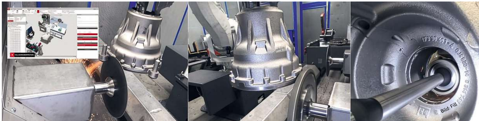
Die extrem kurze Taktzeit ist möglich, weil der Roboter nicht die Werkzeuge zum Werkstück bringt, sondern umgekehrt.
