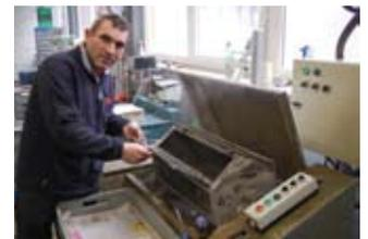
Afrim Shabani ist bei ABW für die Teilereinigung zuständig. Die selbst konstruierten Waschmaschinen sind nicht mehr für alle Anforderungen ausreichend.
