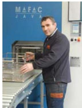
Neues Kernstück der Teilereinigung bei ABW ist eine Spritz-Flutreinigungsanlage MAFAC Java.
