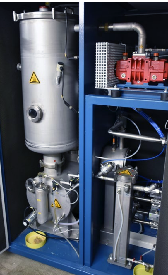
Der kompakte PROWADDEST P60/1 arbeitet nach dem Prinzip des Zwangsumlaufs und ist bei nur 1.790 x 920 mm Aufstellfläche für eine Jahresleistung von 360 m 3 ausgelegt.
