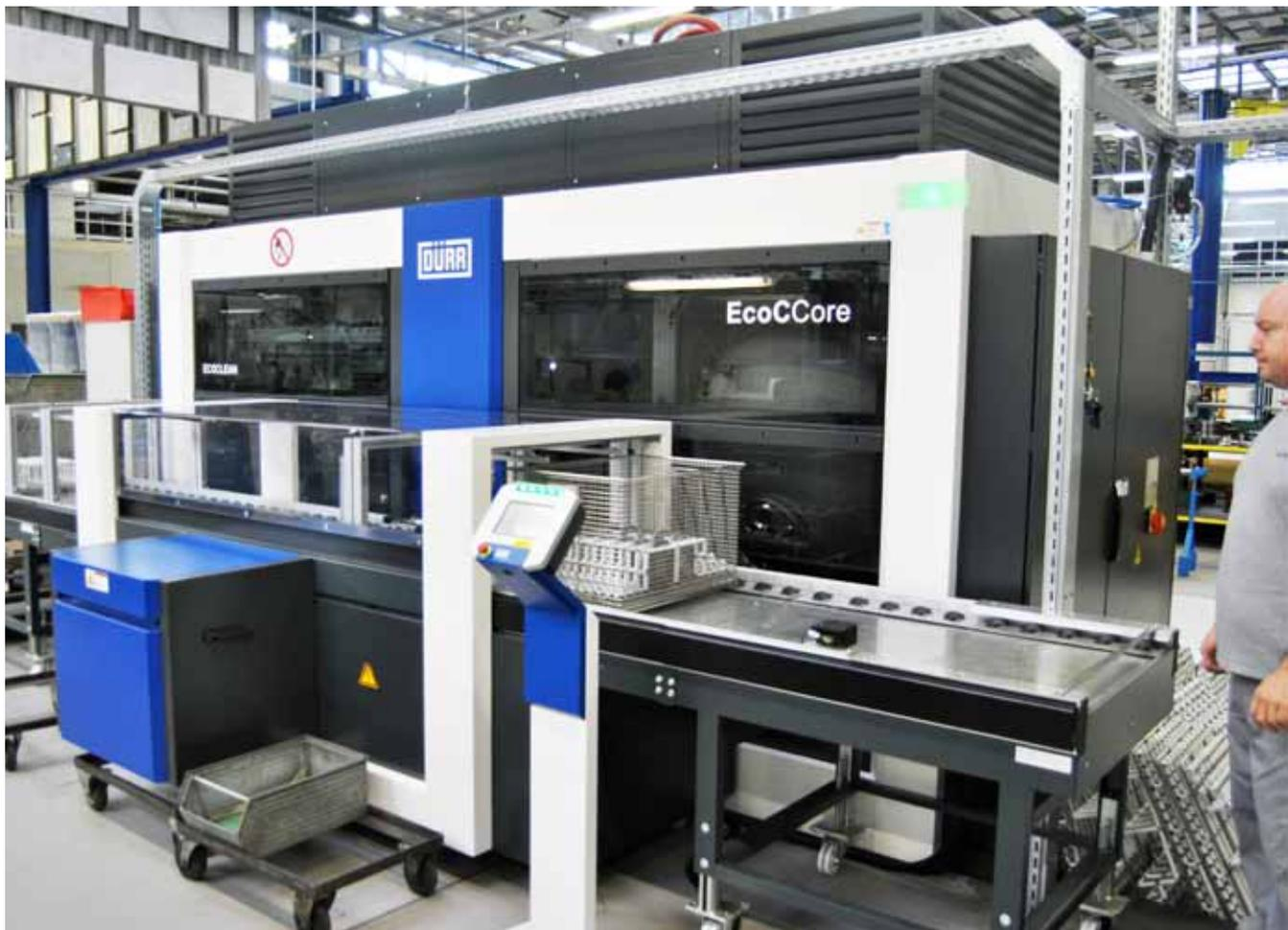
Mitte 2016 erfolgte mit der Inbetriebnahme der über MAP Pamminger bezogenen 100. EcoC-Core von Dürr Eco-clean der Umstieg der Teilereinigung und -konservierung auf Lösemittelreinigung.
