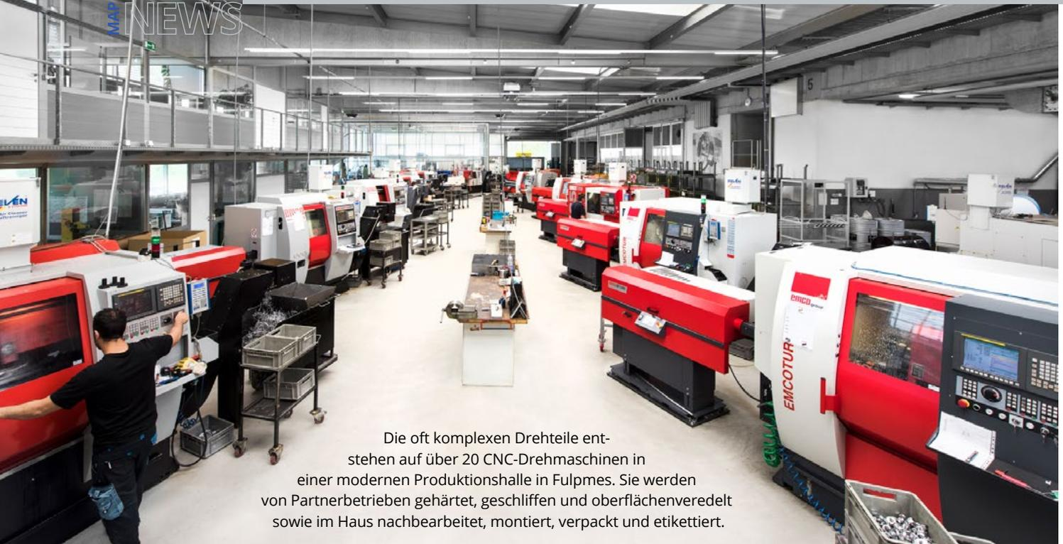
Die oft komplexen Drehteile entstehen auf über 20 CNC-Drehmaschinen in einer modernen Produktionshalle in Fulpmes. Sie werden von Partnerbetrieben gehärtet, geschliffen und oberflächenveredelt sowie im Haus nachbearbeitet, montiert, verpackt und etikettiert.
