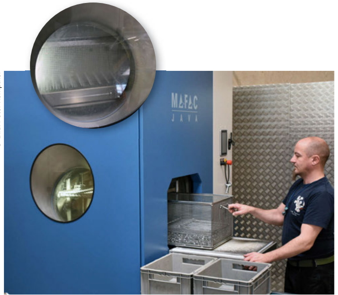
Bei geschlossener Maschine bietet ein seitliches Sichtfenster guten Einblick in den Reinigungsraum.
