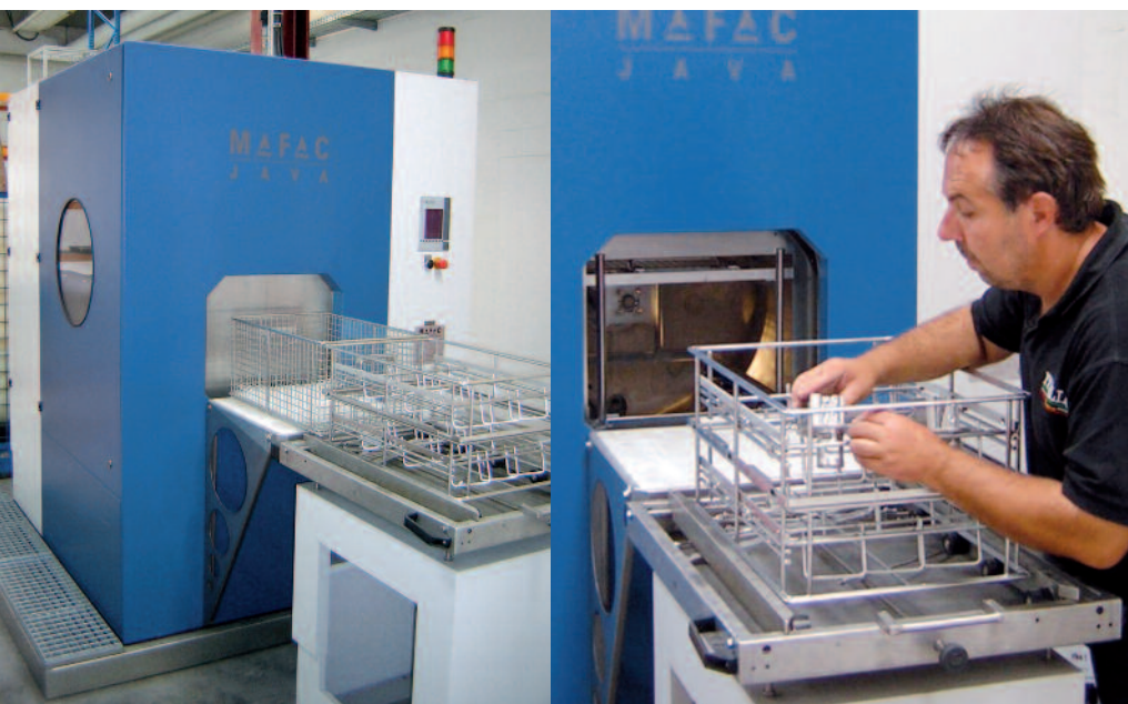
oben links: Erledigt die Teilereinigung im seriennahen Prototypenbau im MAHLE-Werk Wolfsberg: Die MAFAC Java.
