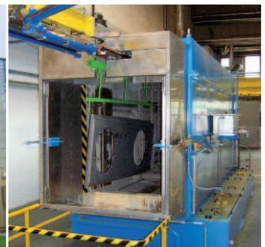
Die kundenspezifisch angepasste BUPI-CLEANER® Portalreinigungsanlage mit durchlaufender Bandförderanlage. Foto: x-Technik
