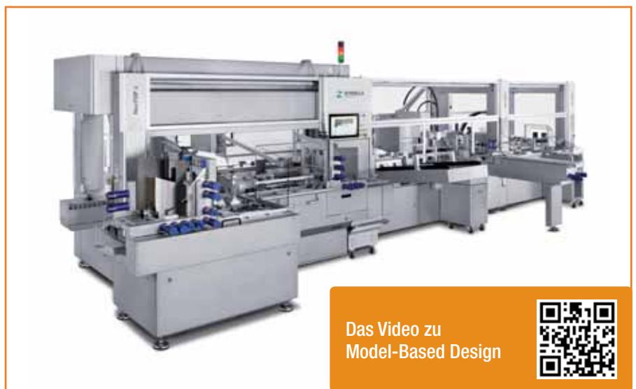
Bei der NeoTOPx entwickelte Dividella das Handling der Schachteln und der einzuklebenden Stege von Grund auf neu. Anpassung des Antriebsstrangs und Neuauslegung des Reglers mittels Model-Based Design sowie Optimierung der Referenz-Trajektorie führten zu einer mehr als 20 % höheren Taktzahl bei gleichem Energieverbrauch.
