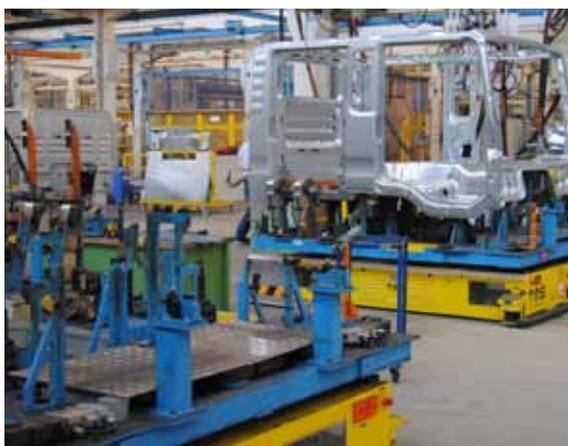
**links** Die 8 Fertigungszellen der Fahrerhaus-Rohbauproduktionsanlage sind mit automatischen fahrerlosen Transportsystemen verbunden.
