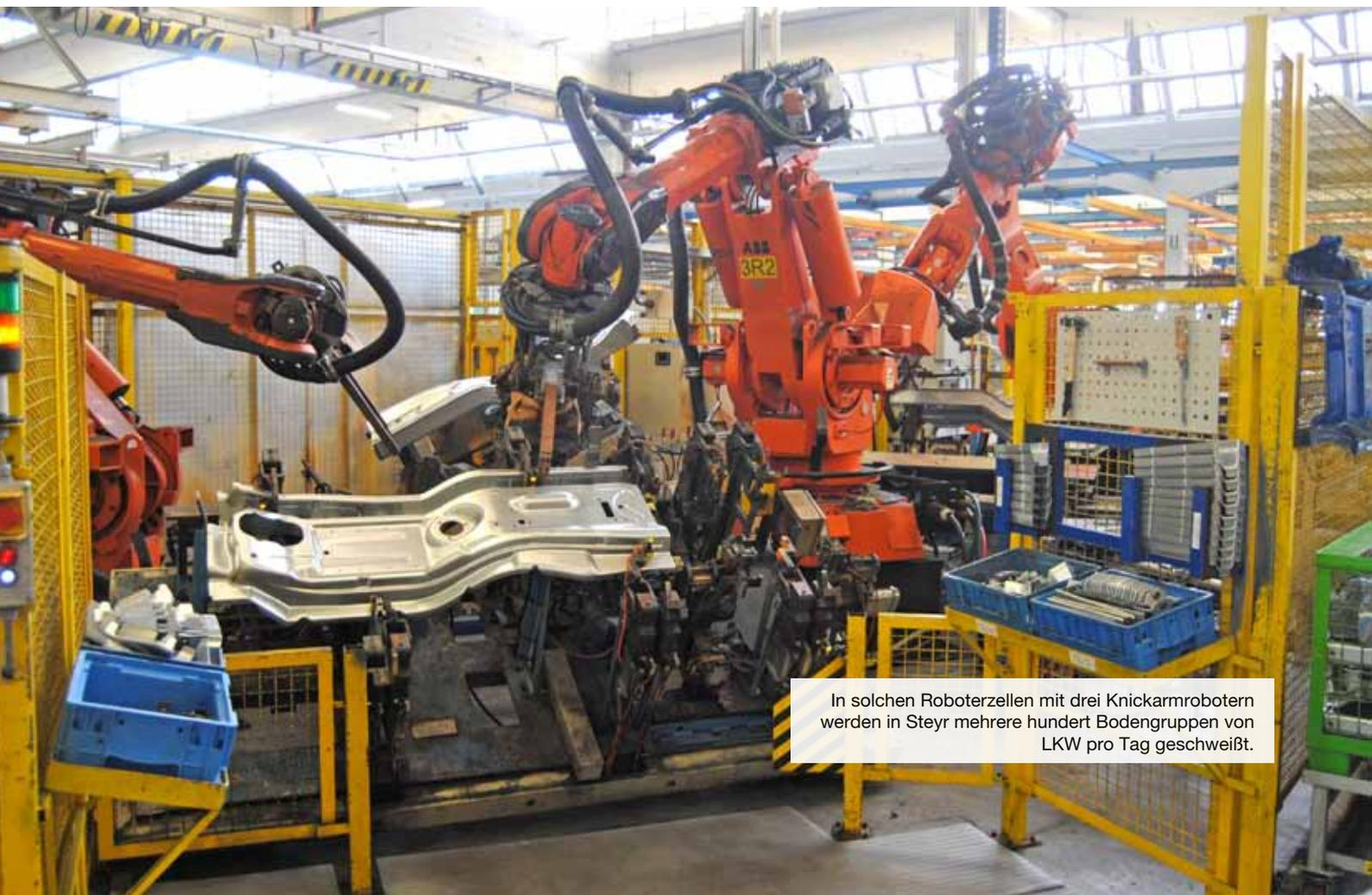
In solchen Roboterzellen mit drei Knickarmrobotern werden in Steyr mehrere hundert Bodengruppen von LKW pro Tag geschweißt.
