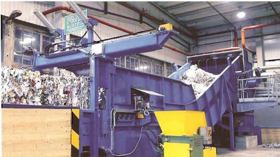
Mit mehreren 10.000 Einzelteilen und Baugruppen nur ein kleiner Teil einer Gesamtanlage: FMW-Altpaperentdrahtungsanlage EXTRACTOR für die Entbündelung von bis zu 180 Ballen Altpapier pro Stunde
