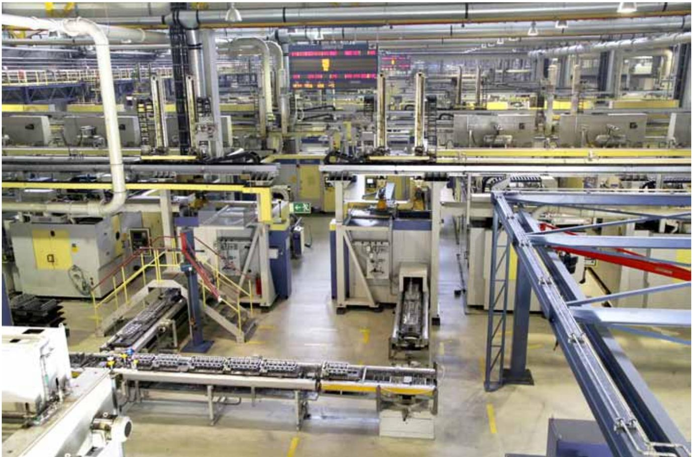
oder Hinzufügen von Bearbeitungszentren angepasst. 2012 wurde eine Kurbelgehäuselinie in Steyr angepasst und um zahlreiche Bearbeitungszentren erweitert, um der wachsenden Nachfrage nach kleineren Motoren gerecht zu werden. Einerseits stellte das eine Herausforderung für die Hochdruckpumpen für die Kühl-/Schmiermittelversorgung dar, andererseits waren ausschließlich für die Herstellung von Sechszylindermotoren erforderliche Einrichtungen innerhalb der Linie nicht ausgelastet.
