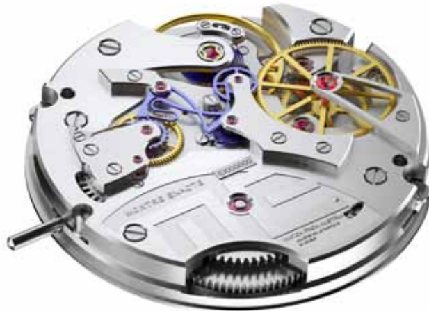
Das aus ca. 200 Teilen bestehende komplexe Werk sorgt für präzise Funktion genau 48 Stunden bzw. 86.400 Sekunden ab dem Aufziehen. Die Bewegung des Viertelzeigers steuert der einzigartige Vierteljumper in Form eines Sektglases (in blau), der durch den transparenten Boden des Uhrgehäuses zu sehen ist.
