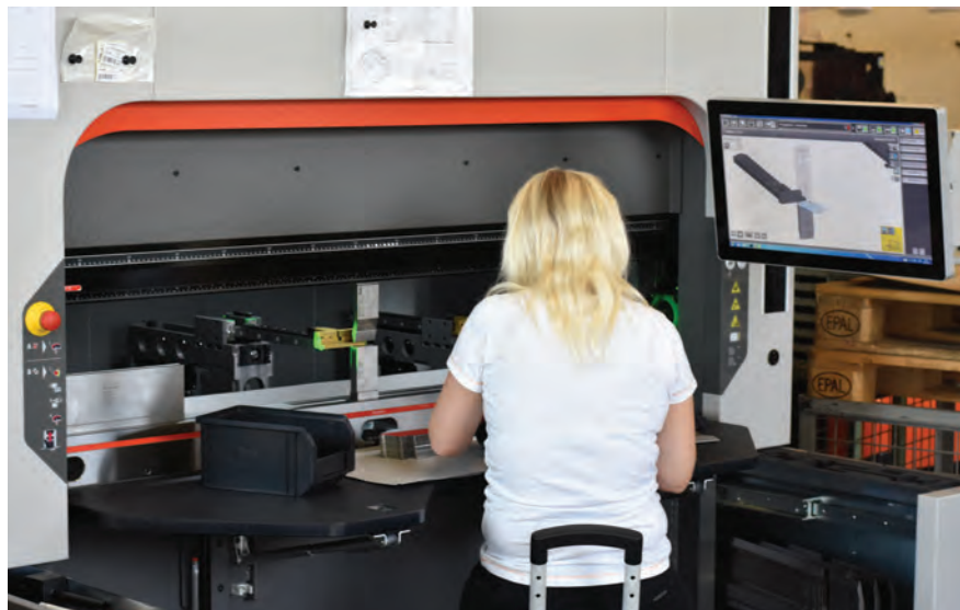
Durch das Anzeigen der Teile auf den Bediengeräten der Blechbearbeitungsmaschinen liegen den Arbeitern stets die aktuellsten, freigegebenen Konstruktionen vor
