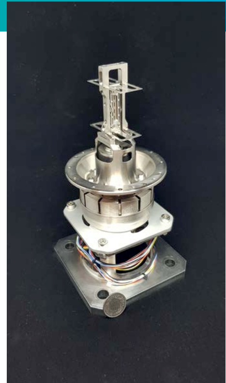
Der Solar Orbiter erforscht in einer gemeinsamen Mission von ESA und NASA die Sonne und ihre äusseren Atmosphäre. Für den bildgebenden Spektrografen an Bord schuf Almatech diesen abriebfreien Schlitzveränderungs-Mechanismus.
