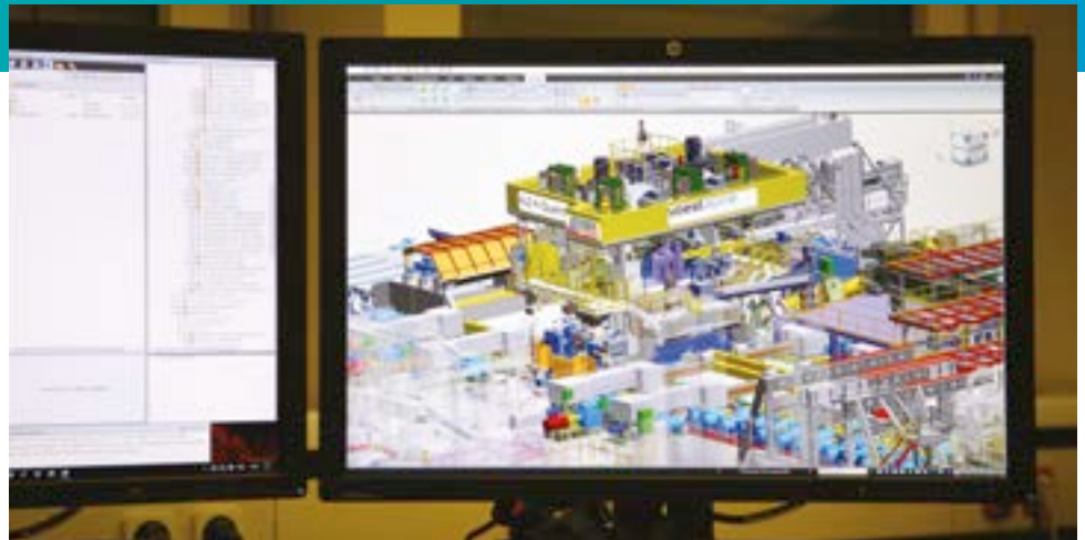
Dank der intuitiven Oberfläche von Solid Edge können Buma-Konstrukteure mit wenig Schulungsaufwand die häufig um neue Innovationen angereicherte Software nutzen. Die gesamte Walzanlage einschließlich Öfen, Entzunderung und Walzgerüst, etc. ist eine Baugruppe mit mehr als 800.000 Teilen.
