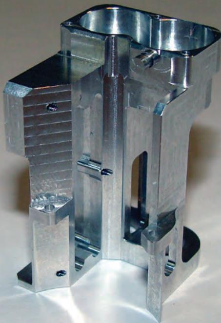
Mit der Software NX CAM und Fünffachs-CNC-Bearbeitungszentren fertigt C-Mill komplexe Präzisionsteile aus Hochleistungswerkstoffen für Anwendungen in der Medizintechnik sowie der Luft- und Raumfahrt.
