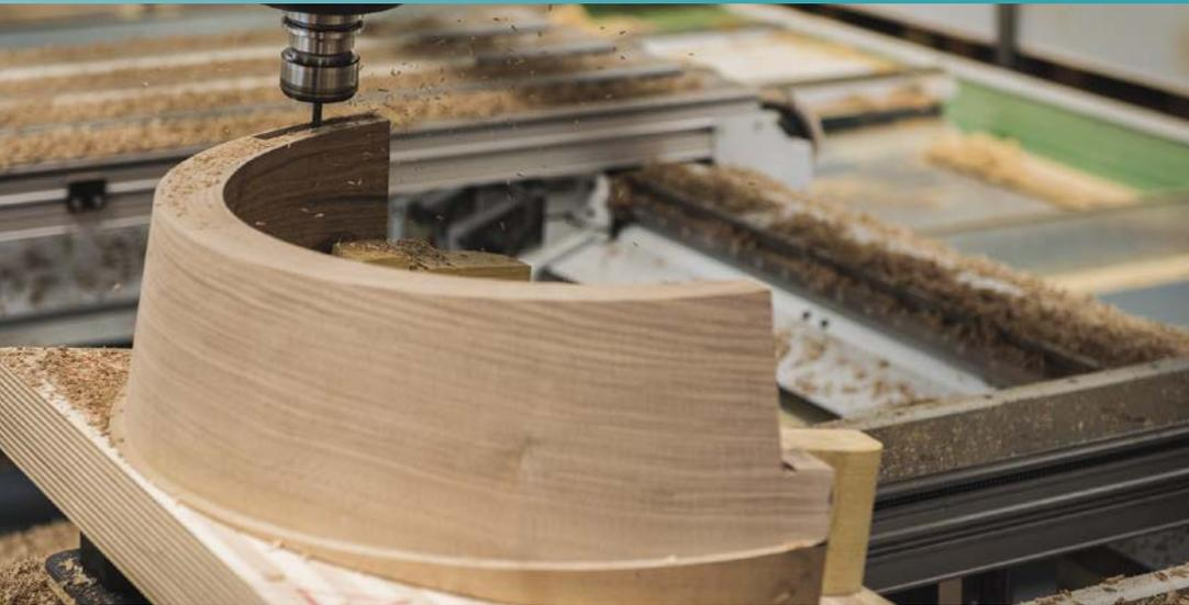
Die Portalanlage ist mit zwei voneinander unabhängigen Aufspanntischen versehen und verfügt über zwei getrennte Bearbeitungseinheiten zur vier- bzw. fünfschichtigen Werkstückbearbeitung, die auf einen gemeinsamen Werkzeugwechsler zugreifen.
