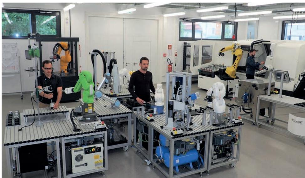
Die Smart Factory der TU Graz ist mit modernsten Bearbeitungsmaschinen, additiven Fertigungszentren und Industrierobotern verschiedener Hersteller in mobilen, autarken Arbeitsstationen ausgestattet.
