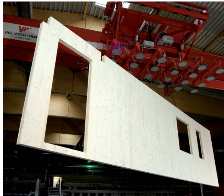
Bauelemente aus Cross Laminated Timber (CLT) oder querverleimtem Sperrholz von Stora Enso werden im Hausbau für Wände, Decken und Dächer verwendet. Die starke Struktur der Querverleimung macht das Material haltbar und verhindert Schrumpfen oder Aufquellen (Modellfoto).
