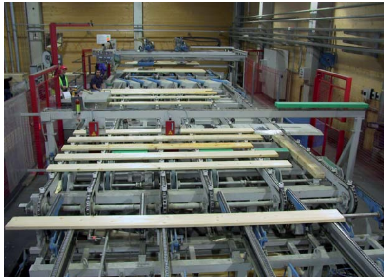
In einer vollautomatischen Anlage werden Bretter sortiert, zusammengefügt, gehobelt und geschnitten, anschließend verleimt und zu Fertigteilen verarbeitet.
