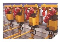
Mittels Frequenzumrichter stufenlos gesteuerte fahrerlose Transporteinheiten mit lastabhängiger Hubwerksregelung verkehren nicht nach Fahrplan, sondern ereignisgesteuert.
