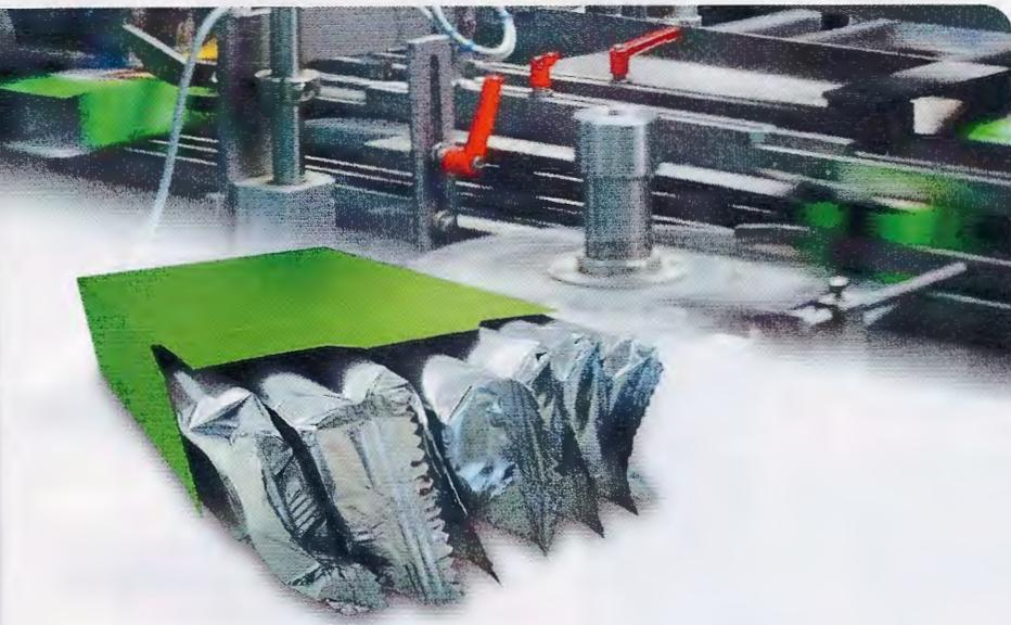
**Bild 1:** 1.800 Riegel in 225 Einheiten à acht Stück verpackt die kompakte Kartoniermaschine RCT 220 Slimline pro Minute.
