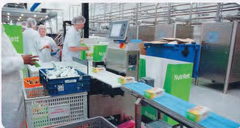
**Bild 3:** Als fertig verpackte Einheiten verlassen die Riegel die Verpackungsmaschine.
