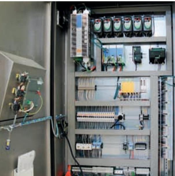
**Links:** Blick in den Schaltschrank: Neben den kompakten und mit den gelben Sicherheitsmodulen gemischten I/O-Systemen der Baureihe »C-Dias« kommen bei Racupack auch Module der Baureihe »Dias« (rechts) zum Einsatz. Beide sind mit den Antrieben der Serien »Dias-Drive 100« (oben Mitte) und »Dias-Drive 300« (ganz links oben) über das Industrial Ethernetsystem Varan verbunden.
