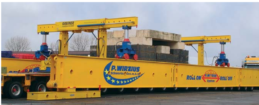
Bei der Generalprobe in der Nähe von Köln mussten 295 Tonnen Ballast über eine Gesamtlänge von 148 Metern mit dem Brückenüberfahrssystem transportiert werden.
