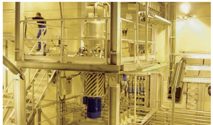
Der ContiMixer, eine kontinuierliche Dispergiermaschine zur Herstellung von Streichfarben ist das Herzstück der Streichfarben-Aufbereitungsanlage.
