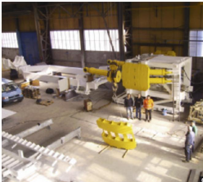
Die Montage der gesamten Nachlaufinstallation (gelb lackiert die Rückfallsicherung in der Nachschleppleinheit) bei Rowa.
