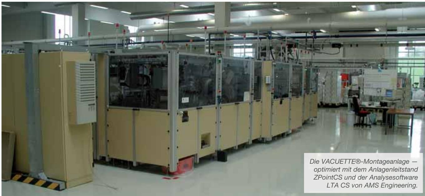
Die VACUETTE®-Montageanlage – optimiert mit dem Anlagenleitstand ZPointCS und der Analysesoftware LTA CS von AMS Engineering.
