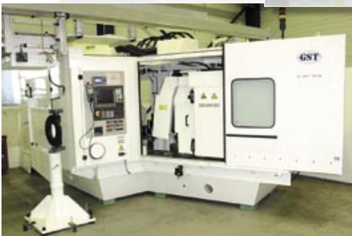
oben: GST-Kurbelwellenschleifmaschine bei Audi – Győr, eingebunden in eine Kurbelwellenfertigungslinie für V6- und V8-Kurbelwellen links: GST-Doppelkopfschleifmaschine für die Bearbeitung sämtlicher Durchmesser, Einstiche und Planflächen bei Getriebewellen in einer Aufspannung
