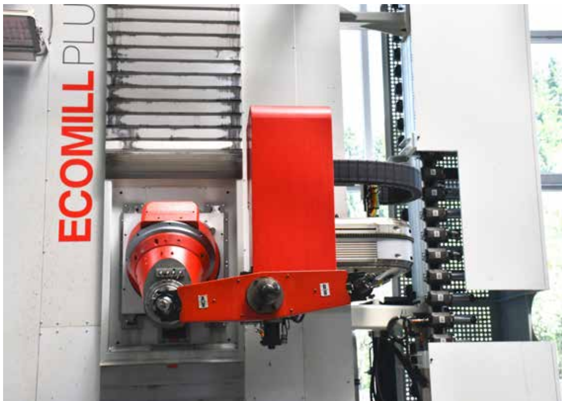
Zur umfangreichen Serienausstattung der Ecomill Plus HPC3 gehört ein automatischer Werkzeugwechsler mit 80 Werkzeugplätzen.
