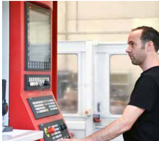
Die CNC-Steuerung Sinumerik 840D sl auf der Bedienerplattform erlaubt die Übernahme der per CAM-Software hauptzeitparallel erstellten und simulierten Programme. (Im Bild Facharbeiter Franz Eder)
