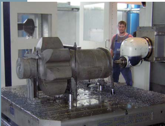
Vier Tonnen Material werden dem Rohling entrissen, um drei Tonnen Pinion entstehen zu lassen.
