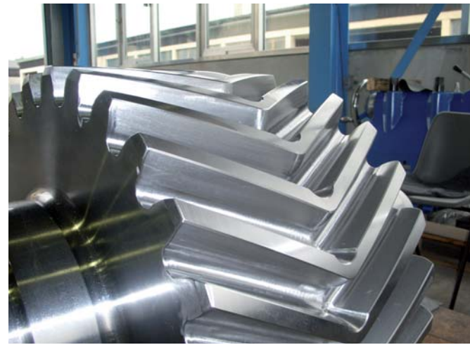
Spezielle Konstruktions- und Fertigungstechnik erfordert dieses Zahnstangenritzel für eine Stoßbank. Es überträgt über eine Pfeilverzahnung mit 30 Grad Öffnungswinkel 2000 PS.
