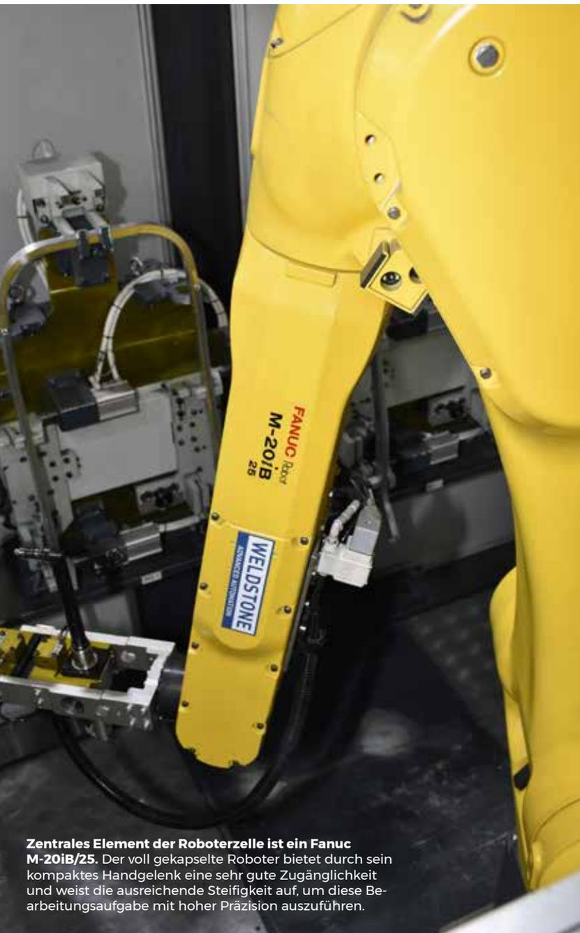
**Zentrales Element der Roboterzelle ist ein Fanuc M-20iB/25.** Der voll gekapselte Roboter bietet durch sein kompaktes Handgelenk eine sehr gute Zugänglichkeit und weist die ausreichende Steifigkeit auf, um diese Bearbeitungsaufgabe mit hoher Präzision auszuführen.
