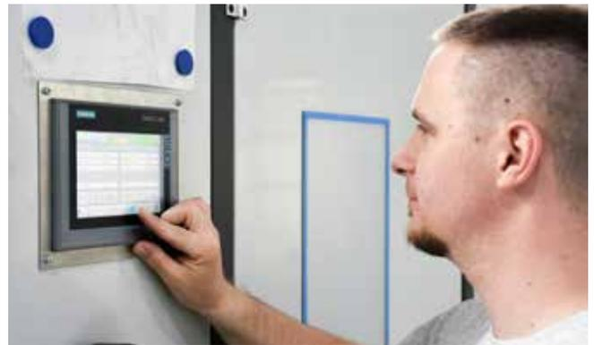
Die Automatisierung durch eine übergeordnete SPS mit Touchpanel ermöglicht dem Bedienpersonal, angesichts eines Spektrums von ca. 20 ähnlichen Teilen, rasch und einfach das richtige Programm auszuwählen.
