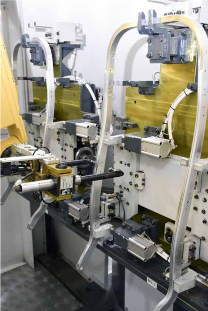
Unter Verwendung von in der Konzernmutter hergestellten Aluminium-Stranggussprofilen produziert die Alu Menziken Euromotive GmbH u. a. Strukturen für Passagiersitze in Flugzeugen. Deren bis zu **120 Bohrungen werden in einer Roboterzelle von Weldstone entgratet.**
