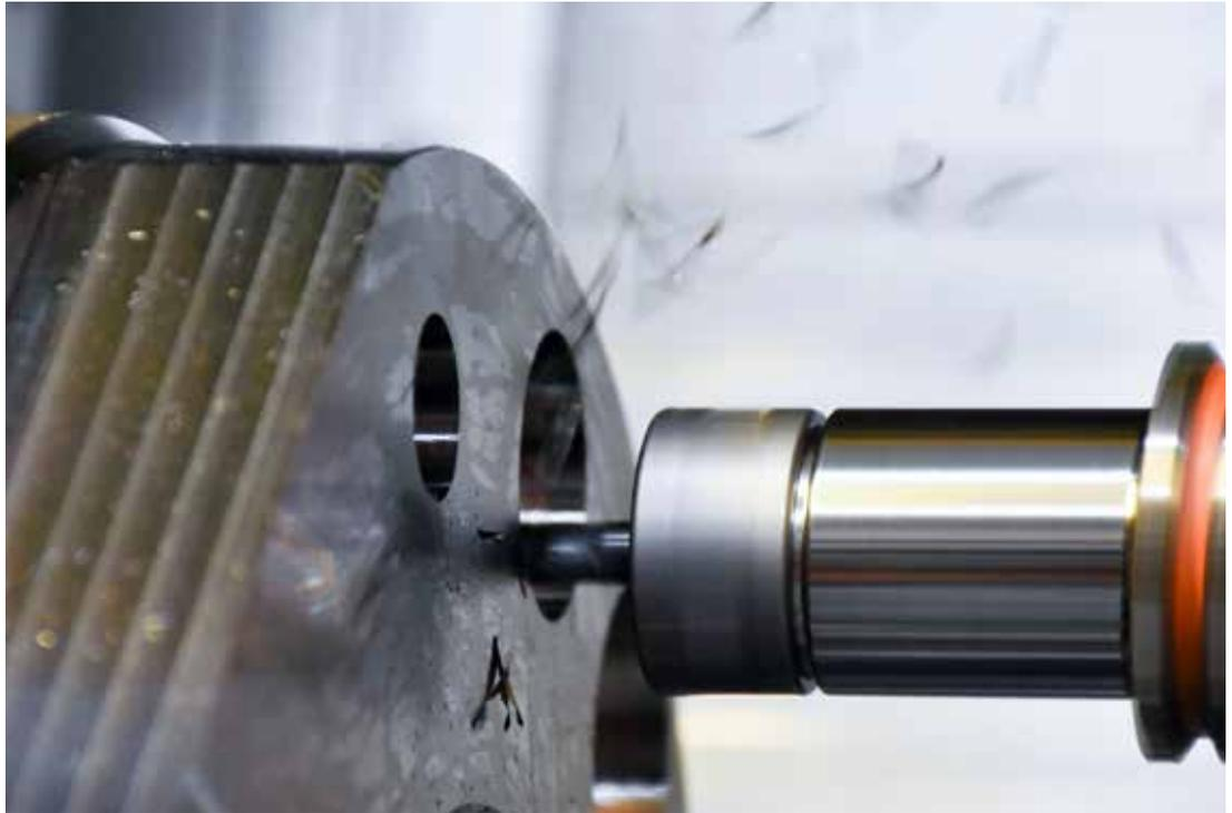
Durch den Umstieg auf das **Vollhartmetallfräs Werkzeug HARVI I TE von Kennametal** kann Zern.at die Senkung für Gelenkflansche um eine Minute pro Bohrung schneller fräsen.
