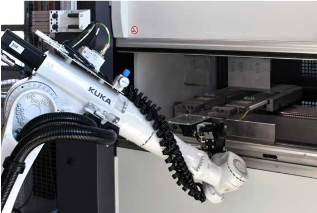
Die Arbeit an der elektrisch angetriebenen Abkantpresse Dyna-Press Pro 40/15 für Teilegrößen von 30 x 100 mm bis 350 x 500 mm erledigt im Automatikbetrieb ein Kuka-Roboter mit patentiertem Multifunktionsgreifer.
