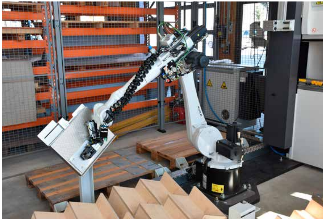
Durch Ablage und Wiederaufnahme auf einem Zentrier-tisch erfolgt die Lagekorrektur der Teile vor dem zentralen Biegeprozess.
